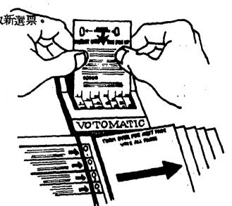
BE SURE THE TWO SLOTS IN THE STUB OF YOUR CARD FIT DOWN OVER THE TWO RED PINS.
